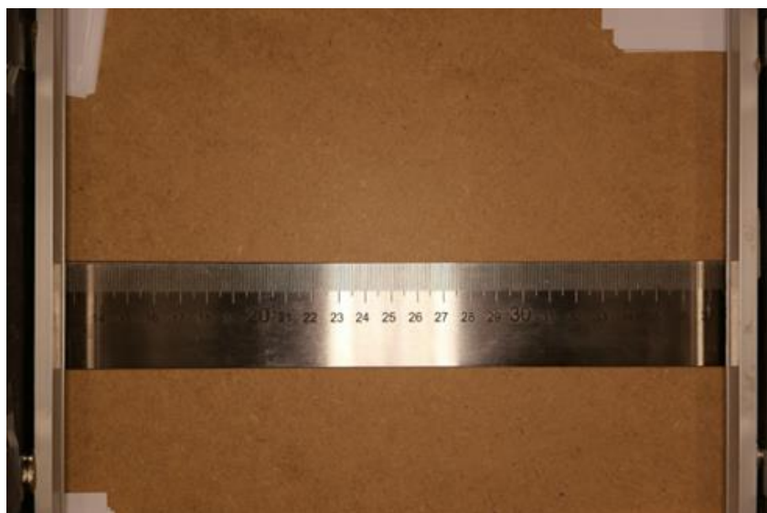
Rys. 8.5. Przymiar kreskowy wykorzystany podczas oceny dystorsji zdjęcia
