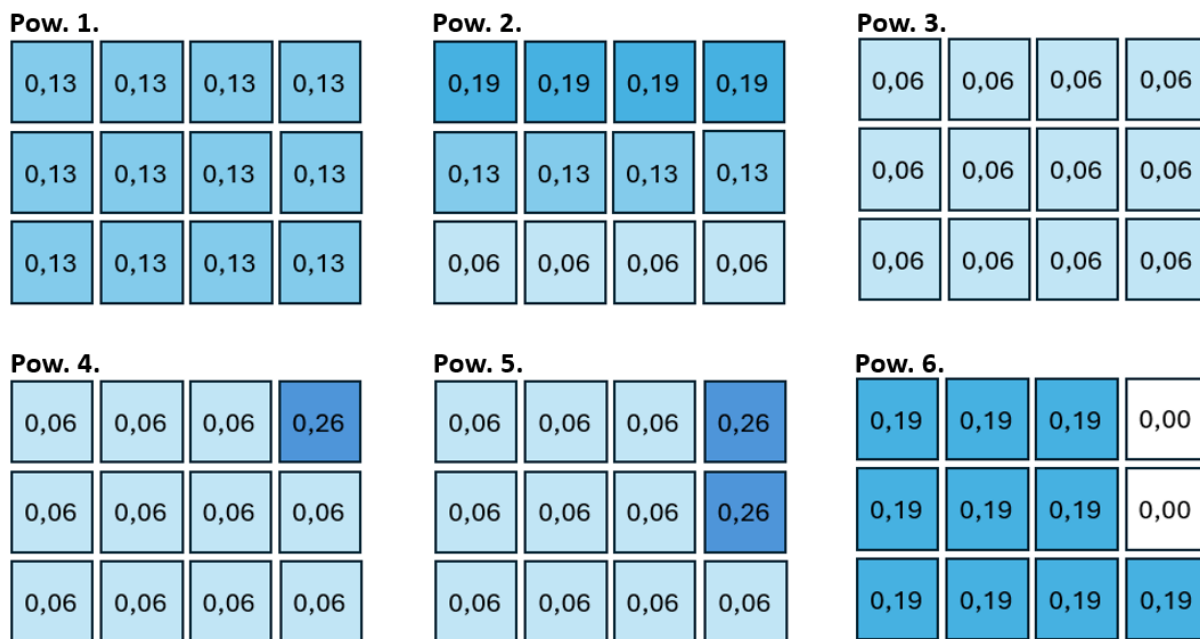
Rys. 9.5. Wyniki badań symulujących 6 powierzchni o niejednorodnym rozkładzie porów: 1) powierzchnia o równomierne rozłożonych porach, udział procentowy porów równy 0,13%; 2) powierzchnia z nierównomiernym ułożeniem porów, średni udział procentowy porów równy 0,13%; 3) powierzchnia o równomierne rozłożonych porach, udział procentowy porów równy 0,06%; 4) powierzchnia o małej porowatości z obszarem o podwyższonej porowatości zajmującym 1/12 powierzchni; 5) powierzchnia o małej porowatości z obszarem o podwyższonej porowatości zajmującym 1/6 powierzchni; 6) powierzchnia o podwyższonej porowatości z obszarem o zerowej porowatości zajmującym 1/6 powierzchni
