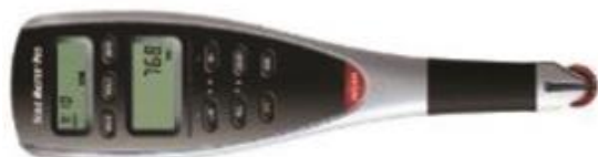
Rys. 4.2. Przykładowy krzywomierz używany do mierzenia obwodu pustek powietrznych [60]
