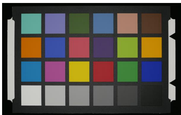
Rys. 8.9. Wzornik koloru Datacolor Spydercheckr użyty do kalibracji kolorystycznej
